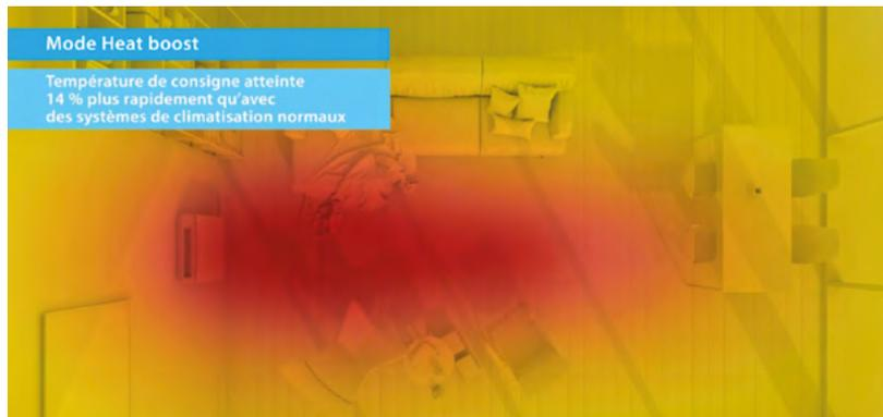
\* En combinaison monosplit uniquement avec les groupes de type RXM-R. Conditions de test de la fonction “Heat Boost” : Démarrage à 2°C temp. extérieure, 10°C température intérieure, et température de consigne de 23°C. Résultat obtenu pour le modèle 3.5 kW.
